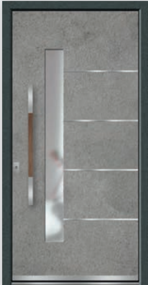
Tanis 2 Mineral . PG 14 Aspect béton, porte d'entrée en verre antireflet, poignée Vinzenz avec bois de chêne, protection de bas de porte en inox affleurant 40 mm, rosette de sécurité pour cylindre avec protection contre les clés affleurant
