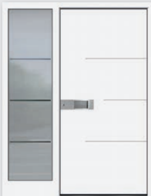
Camillo . PG I Ouvrant caché, partie latérale en verre « Antwerpen », vitrage sablé partiellement transparent, poignée Topas | 620 mm, protection de bas de porte en inox affleurant 40 mm, rosette de sécurité pour cylindres avec protection contre les clés affleurant
